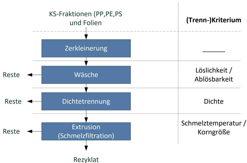
Abbildung 3-2: Prozessschritte für das Recycling von Standardverpackungskunststoffen [UBA, 2016-1]
