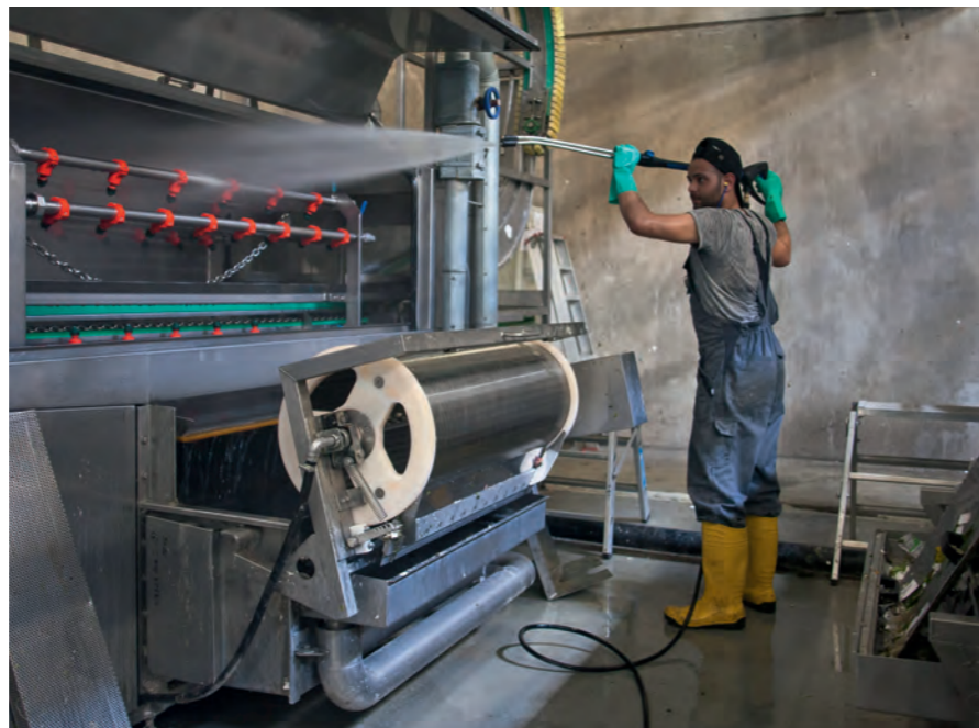
Waschanlage für Mehrwegladungsträger
