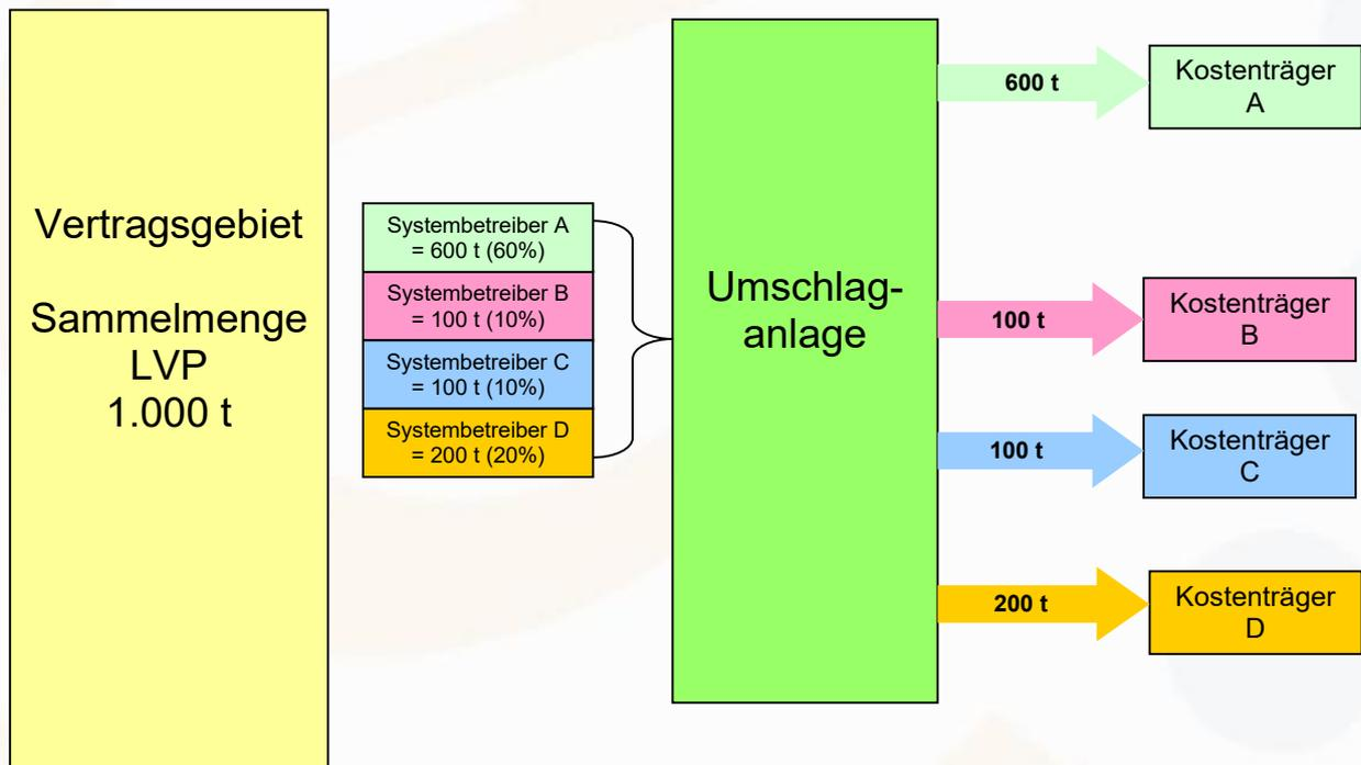
**Anlage 5** Aufteilung der LVP-Mengen über eine Umschlaganlage und eine Sortieranlage
