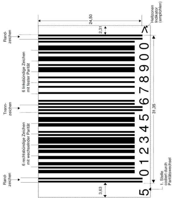
Abbildung 7: Abmessungen für EAN-Barcode der 13-stelligen GTIN
