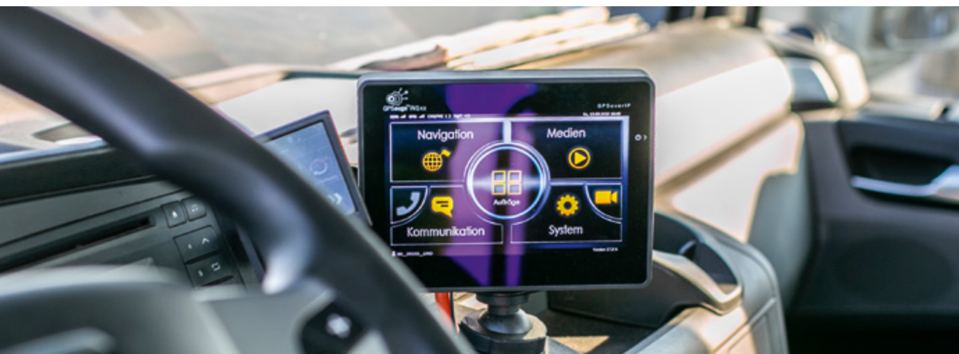
Intelligente Vernetzung: Das Telematik-System im Entsorgungsfahrzeug kommuniziert mit den Containern.
