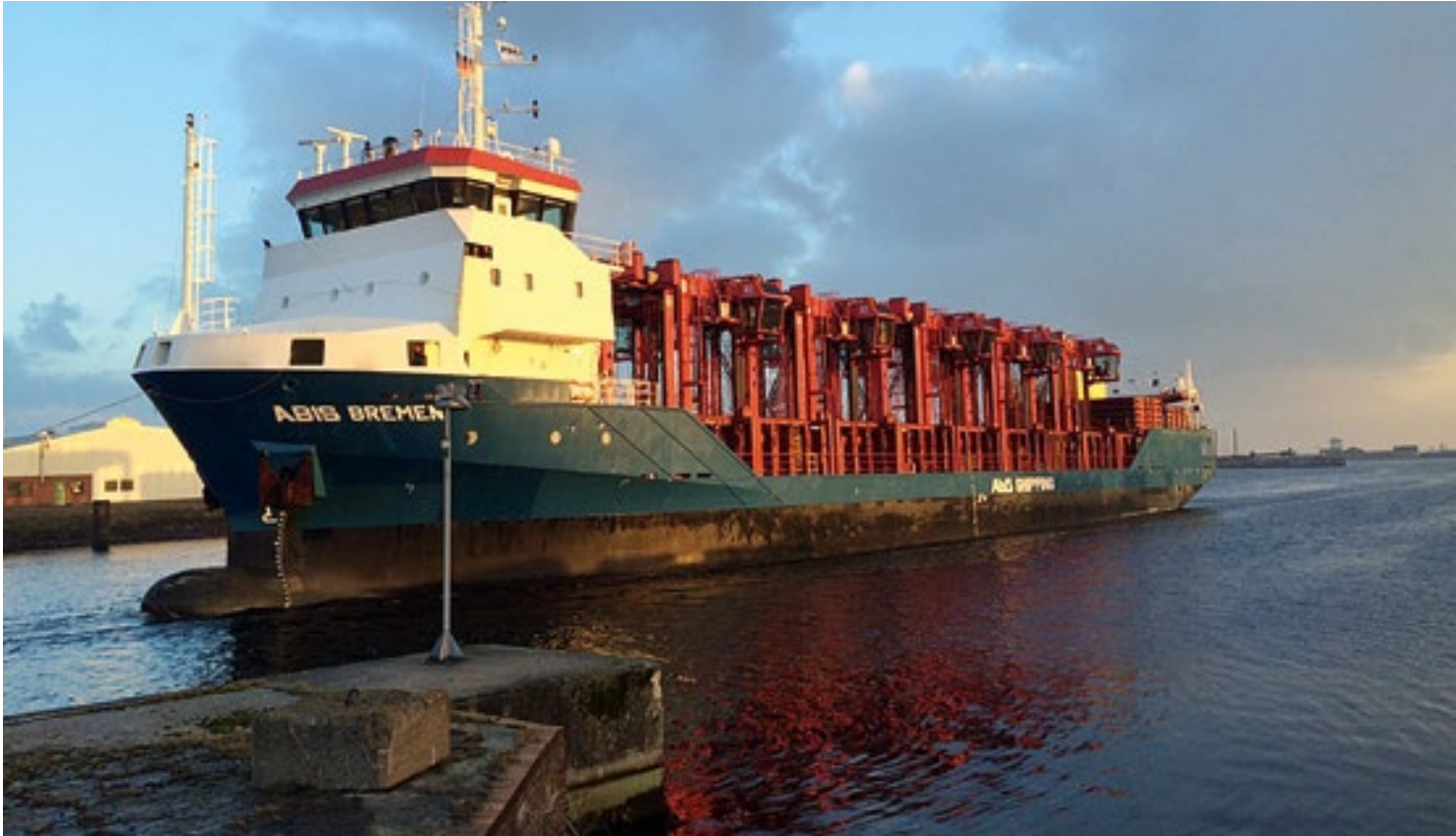
Beeindruckende Dimensionen: Jeder der Containerhubwagen ist 15 Meter hoch und bringt rund 70 Tonnen auf die Waage.
